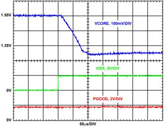
FIGURE 6. VID-ON-THE-FLY TRANSITION FROM 1.55V TO 1.30V
