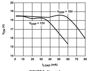
FIGURE 9. V<sub>ON</sub> vs I<sub>ON</sub>
