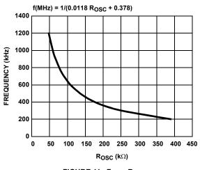
FIGURE 11. F<sub>S</sub> vs R<sub>OSC</sub>
