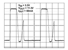
FIGURE 27. LX WAVEFORM - DISCONTINUOUS MODE
