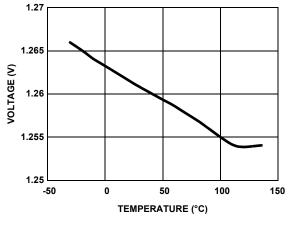
FIGURE 14. V<sub>REF</sub> vs TEMPERATURE
