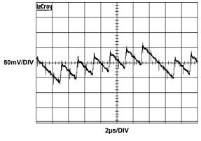
FIGURE 16. V<sub>ON</sub> RIPPLE
